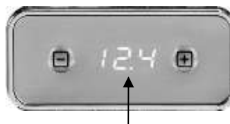
Temperatuur stoom boiler (t2, hier 124°C) -Komma in de 3e positie.
